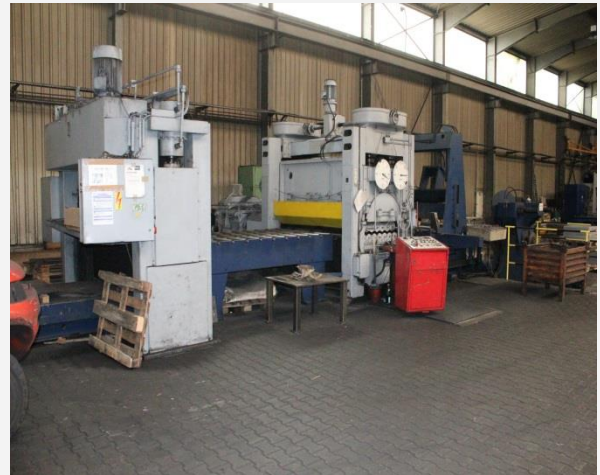
Querteilanlage WMW-BLEMA UBR 2000 x 10 Baujahr: 1975 Blechbreite: 2000 mm Blechstärke: 4 - 10 mm Hubzahl: 1-15 Hub/min
