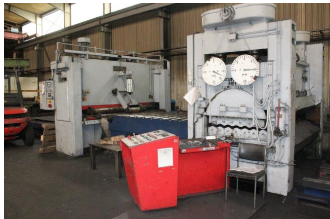
Querteilanlage WMW-BLEMA UBR 2000 x 10 Baujahr: 1975 Blechbreite: 2000 mm Blechstärke: 4 - 10 mm Hubzahl: 1-15 Hub/min
