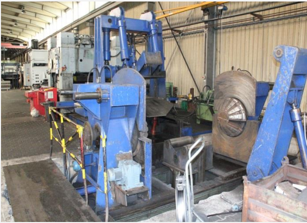
Querteilanlage WMW-BLEMA UBR 1600 x 20 Baujahr: 1983 Blechbreite: 1600 mm Blechstärke: 6 - 20 mm Hubzahl: 1-15 Hub/min
