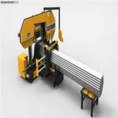
Bandsäge - horizontal KM Kesmak KLS 550 x 700 Baujahr: 2018 Schnittdurchmesser: 0570 mm Sägebandlänge: 7800 mm Schnittbreite: 1,6 mm
