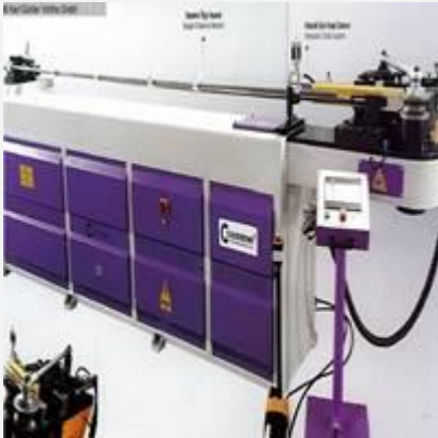
Rohrbiegemaschine CESURBEND PBNC 65 (A) Baujahr: 2018 Rohrdurchmesser: 65 mm Wandstärke: 3,5 mm Biegeradius min.: 70 - 250 mm
