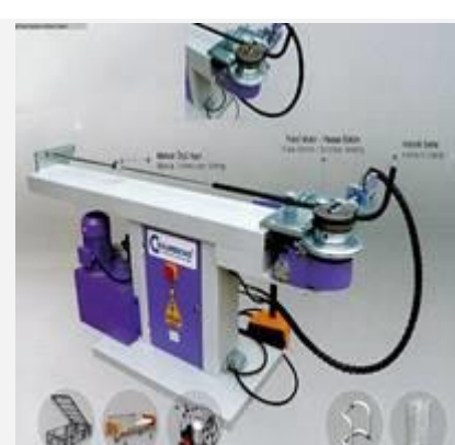
Rohrbiegemaschine CESURBEND PBH 32 Baujahr: 2018 Rohrdurchmesser: 32 mm Wandstärke: 2 mm Biegeradius min.: 50 - 275 mm
